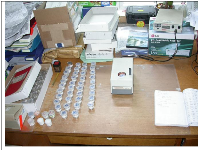
Abb. 1-2: Messung der magnetischen Suszeptibilität an diskreten Proben.
